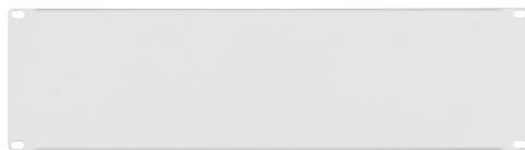
Фронтальные заглушки устанавливаются для скрытия неиспользованного пространства между коммуникационным оборудованием. Служат для защиты от проникновения пыли, в ряде случаев позволяют оптимизировать теплообмен. Улучшают эстетичный вид шкафа. Заглушки можно устанавливать в любые шкафы, выполненные в 19" стандарте.
