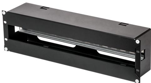
Панель 19" с DIN-рейкой, 3U предназначена для организации ввода внешнего электропитания в шкафы и стойки. Позволяет разместить до 25 автоматов шириной 17,5 мм электропитания по стандарту DIN 43880.
