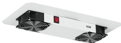
Вентиляторные блоки предназначены для принудительного охлаждения активного оборудования, установленного в телекоммуникационном шкафу, путем отвода теплых воздушных масс из внутреннего объема шкафа. Блоки устанавливаются в специальные ниши на крышах настенных шкафов серии TWC, напольных шкафов серии TFR с шириной и глубиной 600x600.
