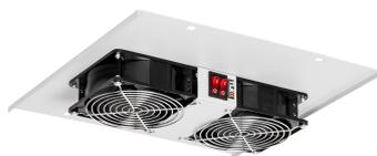
Вентиляторный блок предназначен для принудительного охлаждения активного оборудования, установленного в телекоммуникационном шкафу, путем отвода теплых воздушных масс из внутреннего объема шкафа. Блоки устанавливаются в специальные ниши в крышах и основаниях шкафов TLK серий TF1-R и TW1-R глубиной 450 и 600 мм.
