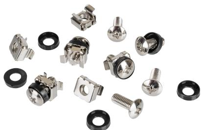
Крепежный комплект предназначен для установки оборудования на монтажные направляющие телекоммуникационных шкафов и стоек. Крепежный комплект состоит из закладной гайки, винта и пластиковой шайбы. Крепежный комплект можно использовать в любом оборудовании, выполненном в 19" стандарте.
