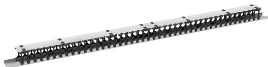
Вертикальный кабельный органайзер серии TLK-OV70-XXU-ZZ (далее - органайзер) применяется для организации укладки кабелей и распределения кабельных жгутов во внутреннем пространстве телекоммуникационных напольных шкафов серий TFA, TFI и TFR. Устанавливается в шкафы шириной 800 мм на кубы-проставки. Органайзер представляет собой металлическое основание с установленными пластиковыми элементами для разведения кабельной продукции и легкоъемными крышками.
