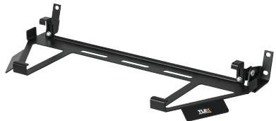
Откидывающаяся клавиатурная полка предназначена для закрепления **полноразмерной** клавиатуры шириной до 474 мм в шкафах и стойках. Конструкция полки надежно фиксирует клавиатуру, занимает мало места и легко переходит в рабочее состояние. В сложенном виде полка закрывает около 200 мм (менее 5U), что не превышает размеров одного сервера.
