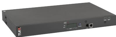
Блок TLK-RPI-AT-A10-M22-WCE-BK выполнен в 19" стандарте с высотой 1U. Блок состоит из 10 электрических розеток IEC 60320 C13. Позволяет производить управление питанием: автоматическое переключение между входными линиями. Максимальная нагрузка составляет 16A для всего блока. С тыльной стороны блока розеток расположено два разъёма IEC 60320 C20 для подключения кабеля питания TLK (может быть 1,8; 3,0; 5,0 метра). Корпус изготовлен из металла.
