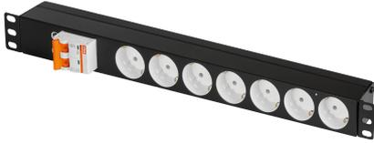
Блок электрических розеток TLK-RS07M-C25-BK в 19" стандарте с высотой 1U. Блок состоит из 7 «евророзеток» (Schuko), соединенных латунными шинами питания марки Л63Т с сечением 6 мм<sup>2</sup> каждая.
