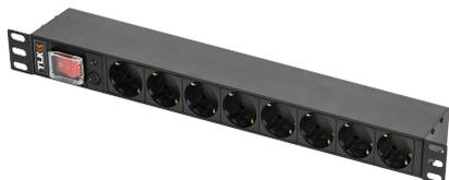
Блок электрических розеток выполнен в виде корпуса с креплением 19" и высотой 1U. Корпус изготовлен из алюминиевого профиля толщиной 1,2 мм, все элементы блока розеток имеют единый контур заземления. Использование корпуса из алюминиевого профиля обеспечивает дополнительную защиту от повреждения при случайных ударах, более высокую термостойкость, облегченную конструкцию, улучшенное охлаждение и дополнительное экранирование от электрических помех.
