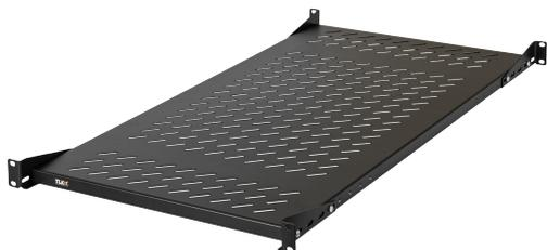
Усиленная стационарная полка предназначена для установки или поддержки тяжелого оборудования в напольных телекоммуникационных шкафах и стойках. Снизу полка укреплена продольными и поперечными усиливающими ребра. Поверхность полки имеет перфорацию для лучшей вентиляции оборудования. Крепление осуществляется на двух парах 19" направляющих в четырех точках. Полка устанавливается в напольные шкафы и стойки в соответствии с таблицей совместимости аксессуаров.
