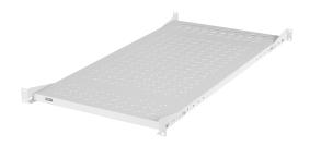
Усиленная стационарная полка предназначена для установки или поддержки тяжелого оборудования в напольных телекоммуникационных шкафах и стойках. Снизу полка укреплена продольными и поперечными усиливающими ребра. Поверхность полки имеет перфорацию для лучшей вентиляции оборудования. Крепление осуществляется на двух парах 19" направляющих в четырех точках. Полка устанавливается в напольные шкафы и стойки в соответствии с таблицей совместимости аксессуаров.
