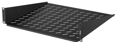
Фронтальная полка предназначена для размещения нестандартного легкого оборудования, инструментов или документации в телекоммуникационных шкафах и стойках. Поверхность полки имеет перфорацию для лучшей вентиляции оборудования. Крепление осуществляется на одной паре 19" направляющих в четырех точках за фронтальную часть полки. Полка устанавливается в напольные шкафы и стойки, настенные шкафы в соответствии с таблицей совместимости аксессуаров.
