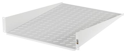
Фронтальная полка предназначена для размещения нестандартного легкого оборудования, инструментов или документации в телекоммуникационных шкафах и стойках. Поверхность полки имеет перфорацию для лучшей вентиляции оборудования. Крепление осуществляется на одной паре 19" направляющих в четырех точках за фронтальную часть полки. Полка устанавливается в напольные шкафы и стойки, настенные шкафы в соответствии с таблицей совместимости аксессуаров.
