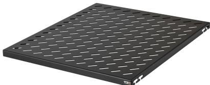
Стационарная полка **увеличенной ширины** предназначена для установки и поддержки тяжелого оборудования. Полка устанавливается в напольные шкафы серии TFA, TFM, TFI-R и настенные шкафы TWI-R, TWC-R в соответствии с разделом совместимости аксессуаров. Поверхность полки имеет перфорацию для лучшей вентиляции оборудования. Крепление осуществляется на двух парах 19" направляющих в четырех точках по боковым сторонам полки.
