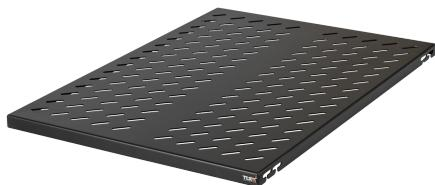
Стационарная полка **увеличенной ширины** предназначена для установки и поддержки тяжелого оборудования. Полка устанавливается в напольные шкафы серии TFA, TFM, TFI-R и настенные шкафы TWI-R, TWC-R в соответствии с разделом совместимости аксессуаров. Поверхность полки имеет перфорацию для лучшей вентиляции оборудования. Крепление осуществляется на двух парах 19" направляющих в четырех точках по боковым сторонам полки.
