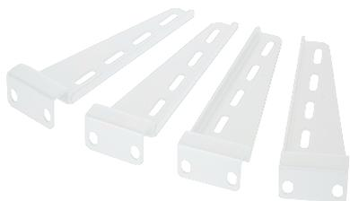
Комплект крепления предназначен для установки стационарных полок серии SHFS на 19" направляющие с L-образным профилем в напольных телекоммуникационных шкафах. Комплект состоит из четырех кронштейнов, четырех крепежных планок и крепежа. Установка кронштейнов осуществляется по бокам стационарной полки при помощи восьми винтов М6 и четырех крепежных пластин с резьбой.
