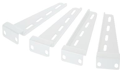
Комплект крепления предназначен для установки стационарных полок серии SHFS на 19" направляющие с L-образным профилем в напольных телекоммуникационных шкафах. Комплект состоит из четырех кронштейнов, четырех крепежных планок и крепежа. Установка кронштейнов осуществляется по бокам стационарной полки при помощи восьми винтов M6 и четырех крепежных пластин с резьбой.
