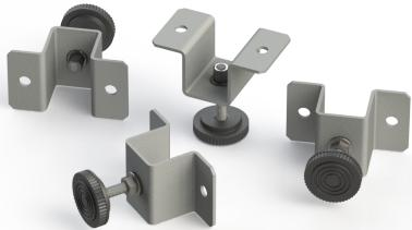
Опоры регулируемые для настенных шкафов серии TWC-R предназначены для компенсации неровностей пола и выравнивания положения шкафа при необходимости установки на пол. Опора состоит из кронштейна с резьбовым отверстием 6 мм, в которое вворачивается резьбовой стержень с опорной чашкой. Выкручивая или закручивая резьбовой стержень можно регулировать положение ее в вертикальной плоскости.
