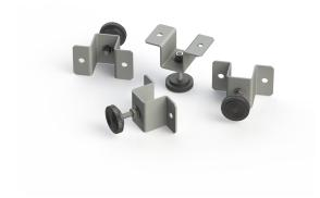
Опоры регулируемые для настенных шкафов серии TWC-R предназначены для компенсации неровностей пола и выравнивания положения шкафа при необходимости установки на пол. Опора состоит из кронштейна с резьбовым отверстием 6 мм, в которое вворачивается резьбовой стержень с с опорной чашкой. Выкручивая или закручивая резьбовой стержень можно регулировать положение ее в вертикальной плоскости.
