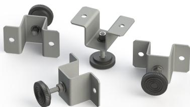
Опоры регулируемые для настенных шкафов серии TWC-R предназначены для компенсации неровностей пола и выравнивания положения шкафа при необходимости установки на пол. Опора состоит из кронштейна с резьбовым отверстием 6 мм, в которое вворачивается резьбовой стержень с опорной чашкой. Выкручивая или закручивая резьбовой стержень можно регулировать положение ее в вертикальной плоскости.
