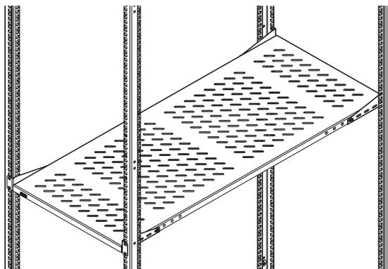
Закрепить полку между вертикальными направляющими при помощи крепежного комплекта.
