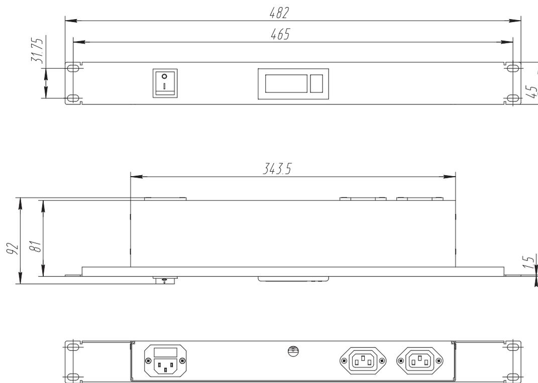
Таблица заказа панели с терморегулятором и датчиком
